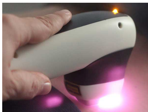
Das Epilations-Handstück des Asclepion MeDioStar NeXT Laser mit integriertem Peltier-Kühlelement
